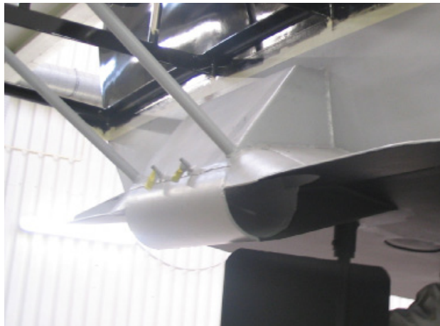
Montage professionnel d'une hélice de poupe (à posteriori) intégrée à la coque.
